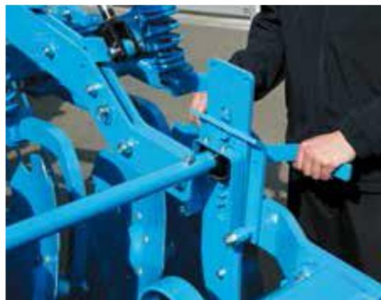
インパクトハローとレベリングハローの高さ調整はセルフロック式で簡単に調整ができます。
